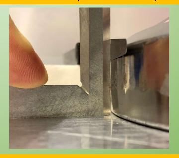
Dieser Eisstock ist nicht regelgerecht, da die 0,1 mm Fühlerlehre einige mm einfällt! Das heißt die Fühlerlehre rutscht in den Spalt ein.
