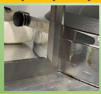
Diese Eisstockkörper ist regelgerecht, Da die 0,1 mm Fühlerlehre nicht einfällt! Das heißt die Fühlerlehre sitzt oben auf.
