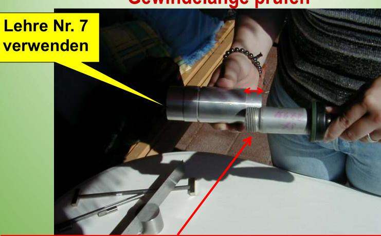
Gewinde mit Übergangsdetail darf nicht länger als das größere reduzierte
