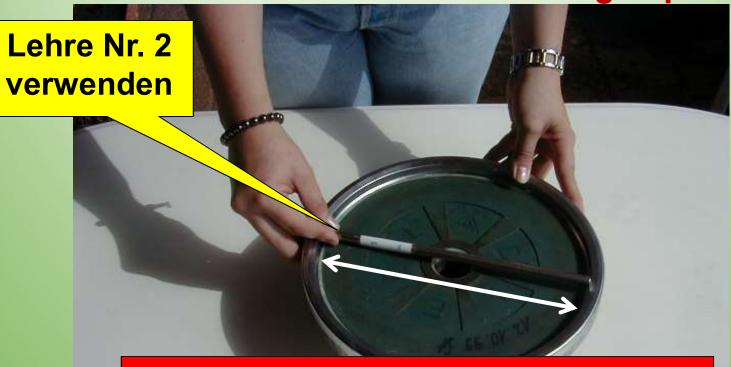
Geht die Lehre in vollem Umfang in den Stahlring entspricht der Stockkörper nicht den Vorgaben Beachte: Falls die Lehre nur an einigen Stellen in den Stahlring fällt, darf der Stockkörper nicht verworfen werden.
